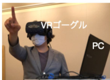
図 2. ヴァーチャルリアリティ技術とモーションキャプチャー技術を応用し、プリズム適応課題を再現するシステム。左はシステムの構成。右はプリズム適応課題の健常者の結果 (未発表)。
