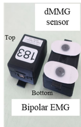
図1 MMG/EMG ハイブリッドセンサ
