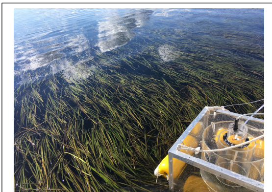
図 - 2 透過フローティングチャンバーによる海草藻場での計測状況
