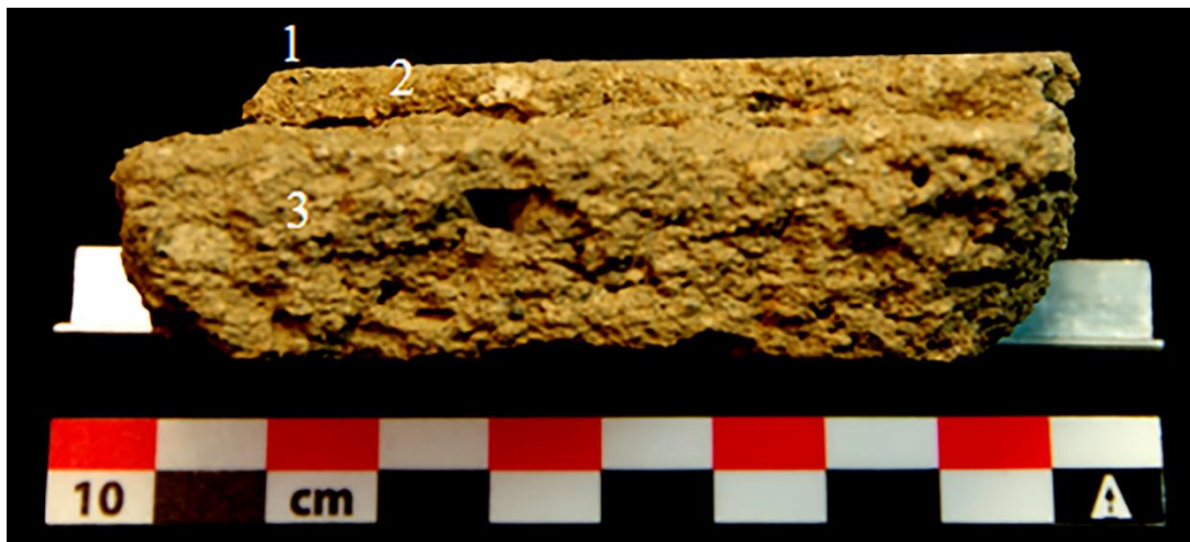
図6 ピラミッドの外壁に利用された土壁（1：磨かれた外面；2：水鍛され粒子が細かな粘土；3：粗い粘土）
