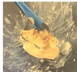
図2 溶剤を添加したLi<sub>3</sub>PS<sub>4</sub>-I<sub>2</sub>系硫化物多量体電解質
