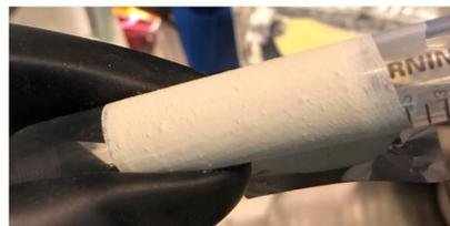
図3 Li<sub>3</sub>PS<sub>4</sub>-I<sub>2</sub>系硫化物多量体を添加したLi<sub>3</sub>PS<sub>4</sub>固体電解質シート
