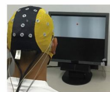
図1 視線活動と脳波の同時計測 コンピュータディスプレイ上で移動ターゲットを追跡する課題中の視線活動と脳波を同時計測した。
