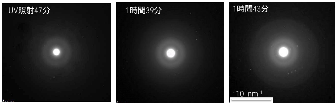
図2 . 82 K で非晶質 Mg_2SiO_4 を非晶質氷を覆い、それに紫外線を照射している時の電子回折像の時間変化 .
