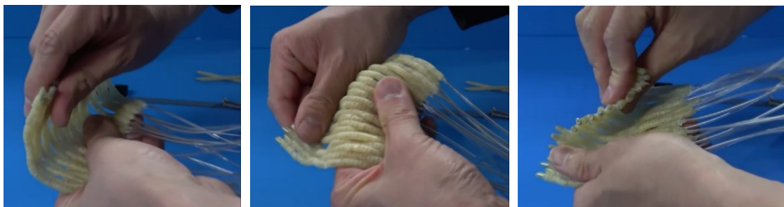
図4：試作機受動なじみ変形の柔剛切替の様子
