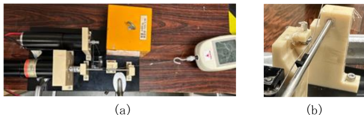
図 2 ワイヤ加振試験装置：(a)全体写真，(b)加振部
