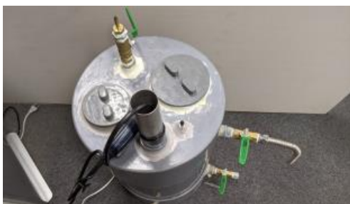
図2 装置の上蓋を汎用塩ビキャップによるものに付け替えた様子
