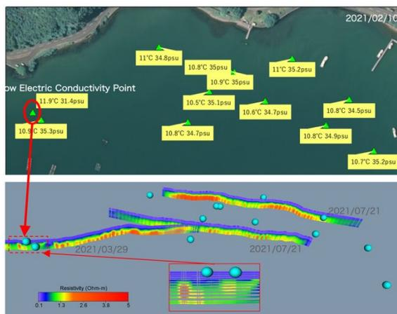
図3 海底下比抵抗分布と海底面付近の電気伝導度および水温の直接測定結果
