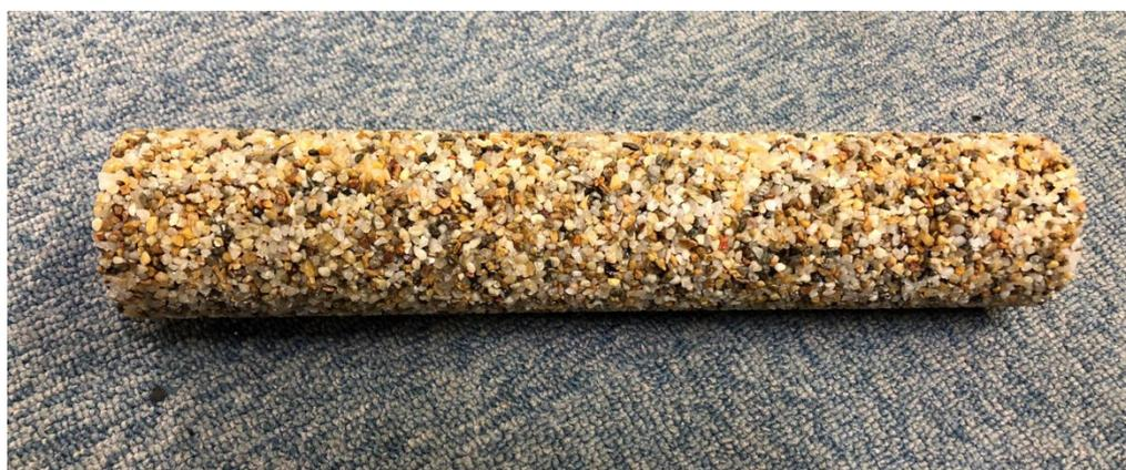
図 2 砂柱 (実験供試体)
