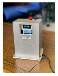
い細胞研究所(代表: 手塚建一)を立ち上げ、地元企業である 4D Pocket 社と共同で、細胞凍結チューブなどにつけられたバーコードを読み取って、ブロックチェーンに記録するデバイス「CellPi」を開発した(写真)。さらに、ブロックチェーン企業テックピューロ社との共同研究で、データを取りまとめるサーバーを中心としたブロックチェーンデータベースシステム「ShizuiNet」を Symbol ブロックチェーン上に構築した(文献 )。ブロックチェーンを用いた精度の高い医療用トレーサビリティ事例は国内外でも注目を集め始めており、新聞やネット媒体で取り上げられた。さらに、医療用大麻や米、自然薯などの農産物トレーサビリティに関する共同研究も開始している。
