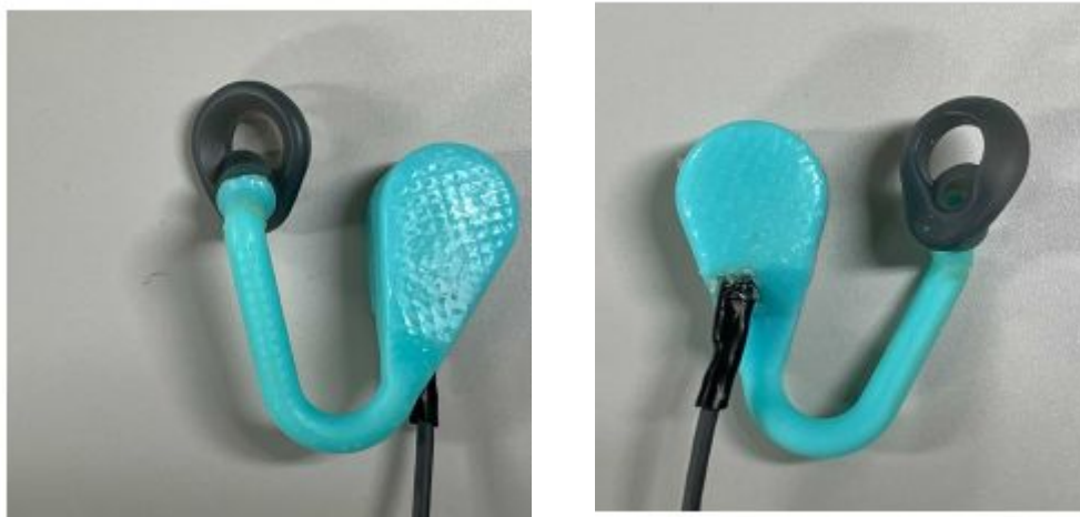
図 2 実際に作成した音響透過型耳音響認証イヤホンの写真
