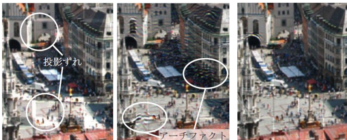
(a) 従来手法での補正結果：ズレやアーチファクトが発生 (b) 提案手法による補正結果
