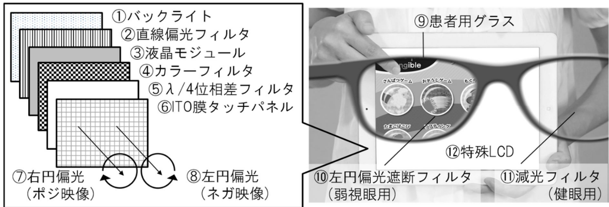
図1 特殊 LCD と患者用グラスの構造及び見え方
