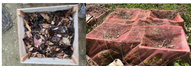
図 8 リターへの Cu-PB 不織布の野外試験写真
