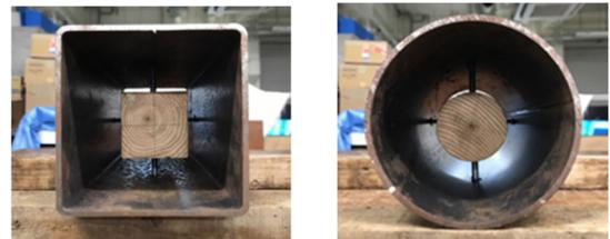
図2 試験体断面(グラウト充填前)
