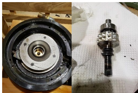
図 2. 故障後の高温超遠心機のタービン部(左)、焼き付いたセラミックボールベアリング(右)
