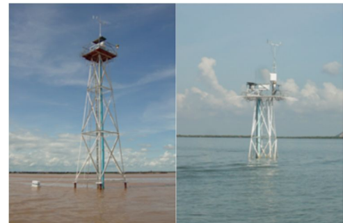
(a)6月(渇水時) (b)11月(氾濫時) 写真1 水文、気象、氾濫に関する長期連続観測((a)(b))
