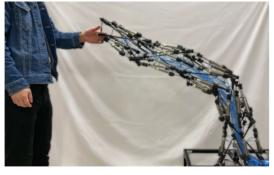
多くの柔軟なアクチュエータで拮抗・冗長に駆動されるという抽象的特徴だけ突き詰めながら,不要な摩擦や機械的干渉を避けるアプローチに切り替えた.テンセグリティマニピュレータは,テンセグリティと呼ばれる構造を採用している.テンセグリティとは,複数の剛体の空間的な配置が,互いの間に張力を加えることで安定になった構造を指す.その中には,剛体としては棒状のパーツだけで,全てのパーツの間で接触が生じない構造がある.開発したテンセグリティマニピュレータでは,その構造を採用することで40本というアクチュエータを組み込みながら摩擦や機械的干渉を極力避けた.このロボットプラットフォーム開発については,2022年度のIEEE/RSJ International Conference on Intelligent Robots and Systems(IROS 2022)で発表するなど,複数の研究成果に繋がった[Y. Yoshimitsu et al. 2022].
