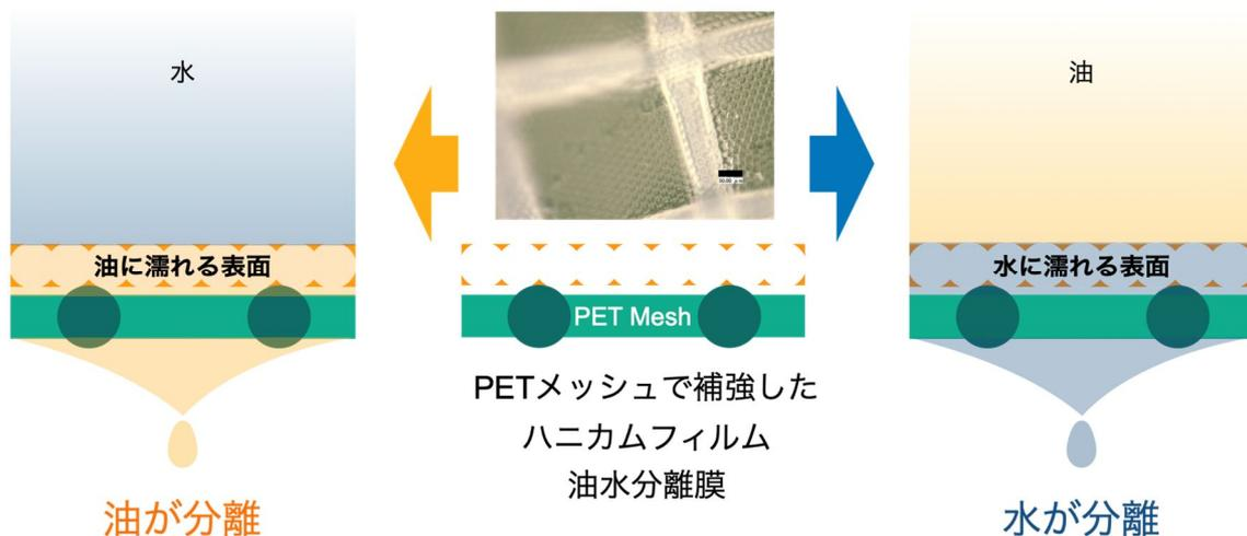
図 2 . ハニカムスキャフォールドを用いた油水分離膜 ( *Adv. Mater. Interf.* (2022) )
