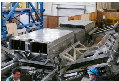
図7 LHC-ALICE 実験にインストール直前のDi-Jet カロリメータ DCal
