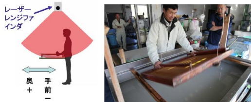
図4 レーザによる紙漉の細かな動作計測
