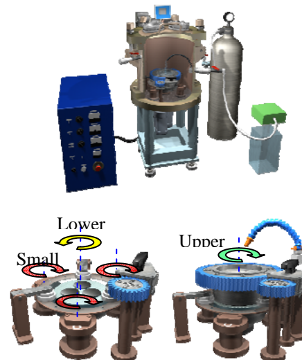
図 1 設計したベルジャー密閉型両面同時 CMP 装置の内部構造と運動形態を示す模式図
