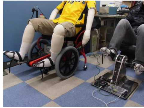
図2. 作製したBMI足漕ぎ車椅子とマスタ・スレーブ駆動用のエルゴメータ
