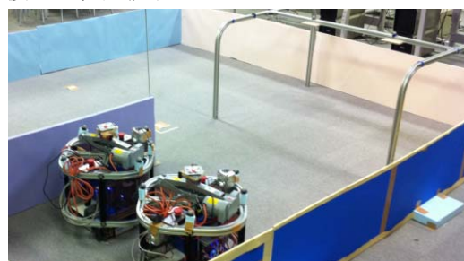
図 14 実空間での共同運搬協調タスク検証
