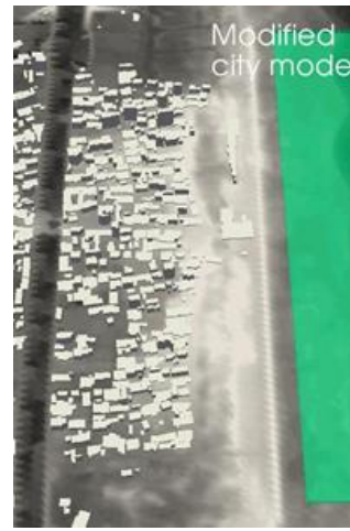
GISから自動構築された仙台市太平洋沿岸地区の都市モデル(SPH法による津波解析用)
