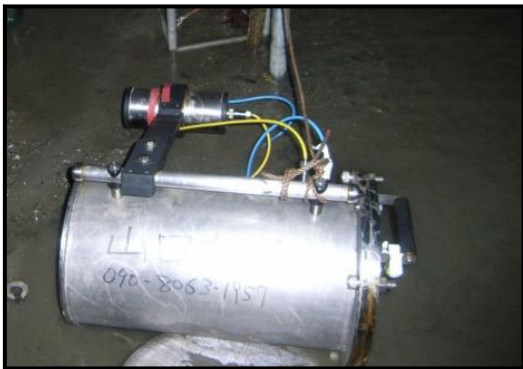
写真1. 独立電源による水中設置型撮像装置
