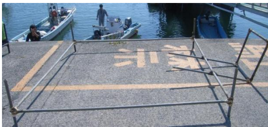
写真8. 海底設置前の2m×2m コドラート 四隅に電極を設置
