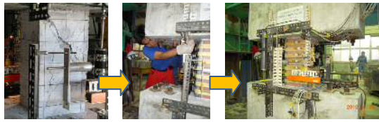
写真 応急補強手順例
