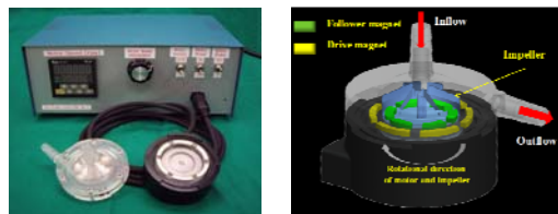
図 4 : TinyPump システム図と構造図
