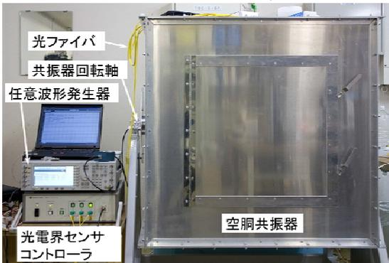
図4 非侵襲温度計測システム
