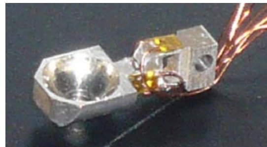
図12 ひずみゲージを配線した固定側グリップ
