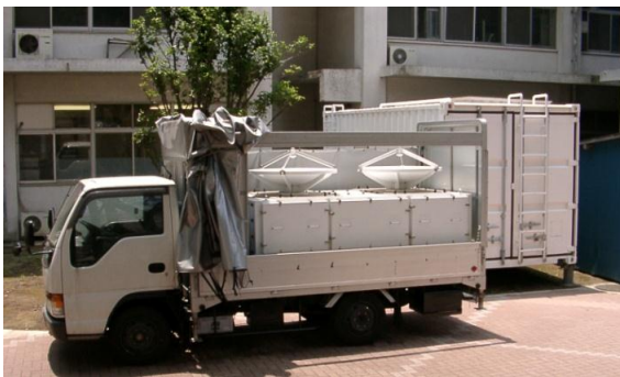
図1. トラックの荷台に搭載された高感度ミリ波雲レーダ FALCON-I。後ろの白いコンテナが船舶搭載用で、FALCON-I をその中に設置する。
