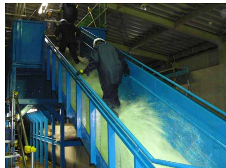
写真-1 階段部での避難実験の様子
