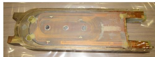
図5 新規開発した耐放射線シアネートエステル樹脂で真空含浸した練習用コイル。
