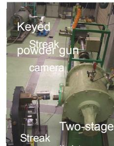
図 3-1. キー付火薬衝撃銃と二段式軽ガス銃の写真
