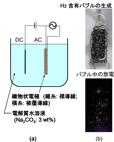
図2 電解質水溶液中の(a)電気分解で生成されたバブルと (b)その中での放電の様子
