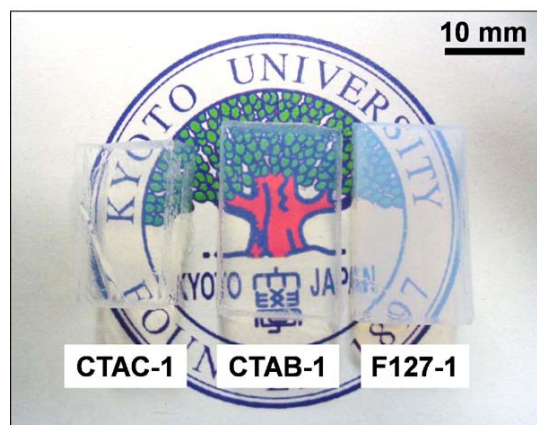
図 1 得られた MSQ エアロゲルの外観。それぞれ、使用した界面活性剤に基づいたサンプル名が付与されている。
