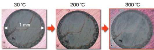
図5 TEMグリッド上の極薄自立膜の各温度での光学顕微鏡像
