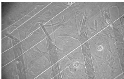
図9 幅 50\ \mu\text{m} の細胞が接着したポリ乳酸
