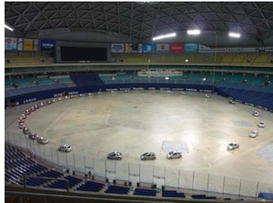
これまでの解析では、サーキット実験における渋滞発生が起こる臨界車両密度は、平均車両間隔で約 8.8~10.0m であり、このあたりが 300m 程度の走行の長さ・速度スケールにおける臨界車間の範囲であり、渋滞形成が起こる一様流の不安定相の領域と思われる。高速道路における臨界車両密度との比較には物理的なスケール変換が必要だが、実験により世界で初めて臨界密度の数値を特定した。また平均車両 8.8m 以下の高密度では、渋滞は発生せず、低速な一様流が観測された。高密度状態における低速一様流の存在については、高速道路における観測は難しく、世界的な議論になっており、我々はボトルネックのないサーキット実験により初めて見出した。この成果は、交通渋滞の発生が多体相互作用による動的な相転移現象であるという物理理論を裏付ける重要な証拠となるものである。
