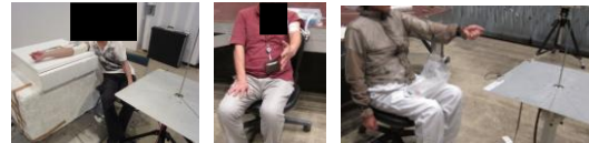
図3 上肢姿勢とシールド効果のRE評価試験（計測用アンテナから供試体までの距離は1m）
