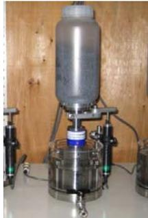
(c) 低鉛直圧膨潤変形試験装置
