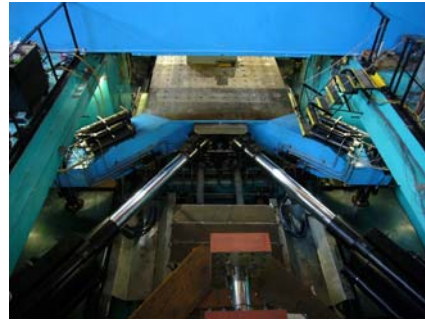
図6 実大免震装置の多方向加力試験機 (UC San Diego, SRMD)
