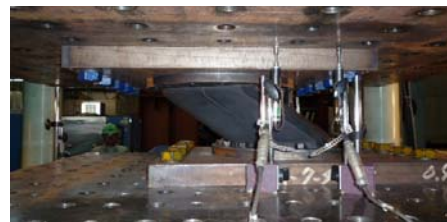
図3 積層ゴムの加力試験状況
