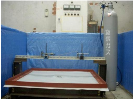
写真3 開発したエアバッグ耐風性評価試験装置
