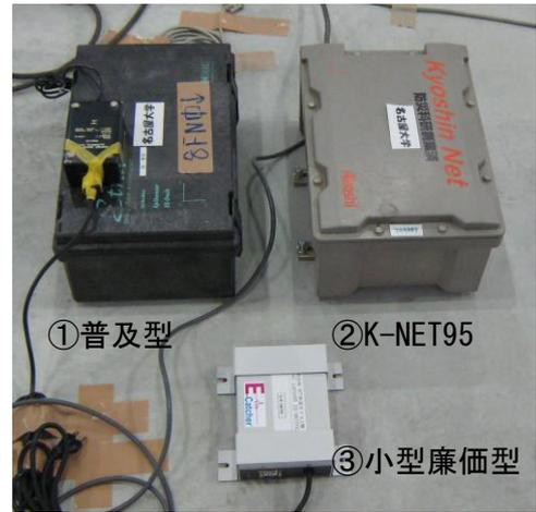
図 4 3 種類の強震計の特性テスト
