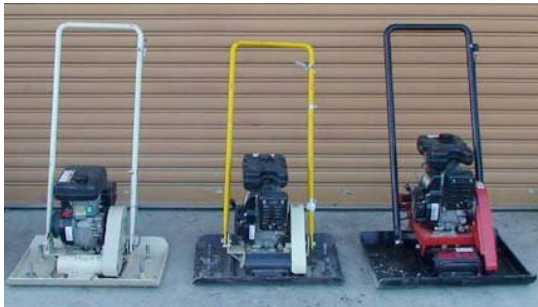
写真-4 ポーラスコンクリート仕上げ機
