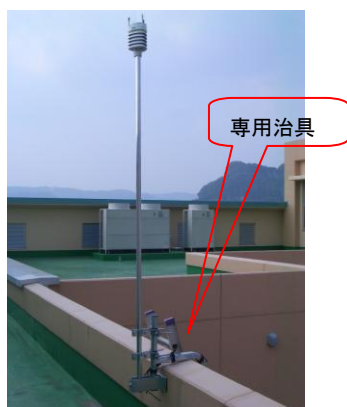
図6 中学校屋上のセンサ設置方法
