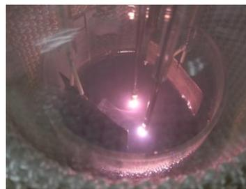
図 9 多電極放電によるプラズマ誘起電解
